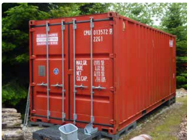
Figur 2.1 Uisoleret 20 fods container kan anvendes til teknikrum.
